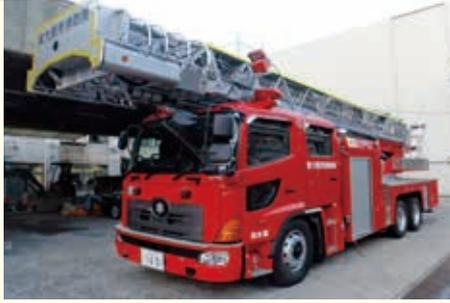
平成26年12月14日に40m級梯子車が西本署に配備されました。この梯子車は従来の梯子車より、大型の梯子先端バスケットが搭載され一度に救助できる人数が増加しており、また各種装備も一新され、現場での多彩で安全な救助活動が行えるようになっています。当局には2台の40m級の梯子車が配備されて、東大阪市全域の高層建物等での火災及び各種災害に対応しています。
