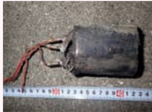
プラスチックの容器が焼失し内部の金属容器も破損
